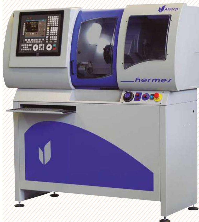
**Multi CNC.** Programmazione e visualizzazione di emulatori FAGOR, SIEMENS e FANUC. PC, touch-screen e tastiera inclusi
