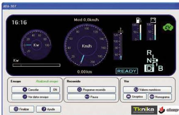
Il trainer hardware è un simulatore di guida (cambio, velocità, carica della batteria, indicatore del carburante). Tutte le azioni eseguite sul pannello sono rappresentate sul cruscotto del software.
